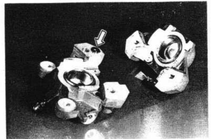
6. Einen Lappen über den Kolben legen, damit er nicht herauspringt, und Kolben mit Druckluft herausdrücken.
