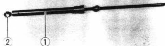
19. Staubdichtung entfernen.
