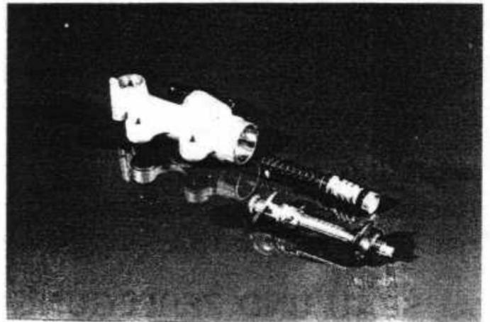
11. Anschluß und O-Ring entfernen.
