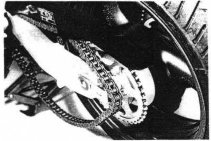
6. Hintere Kettenradtrommel aus dem Rad ziehen.
