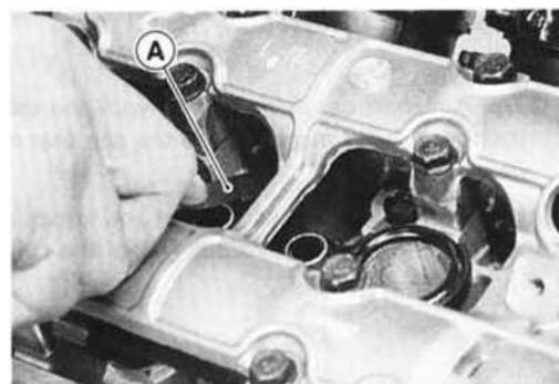
Поверните #4 поршень в ВМТ в конце такта сжатия:
