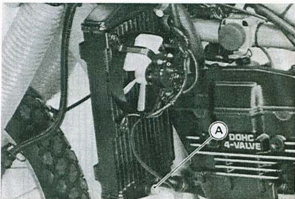
A. Radiator Fan Switch
