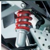
Hinterradaufhängung: Ein robustes Zentralfederbein mit langem Federweg dämpft die Bewegung der steifen Schwingen.
